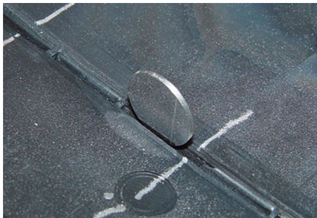
Figura 3. Posizionamento di target a disco all'interno di una giuntura.
